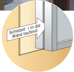
Glas-Schiebetür 1-flügelig, verdeckt in die Wand laufend (siehe Zeichnung Lupe), Glasart: "Planilux (klar)"
